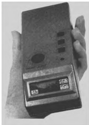
Slika 4 Merač radioaktivne kontaminacije sa GM brojačem kao senzorom
