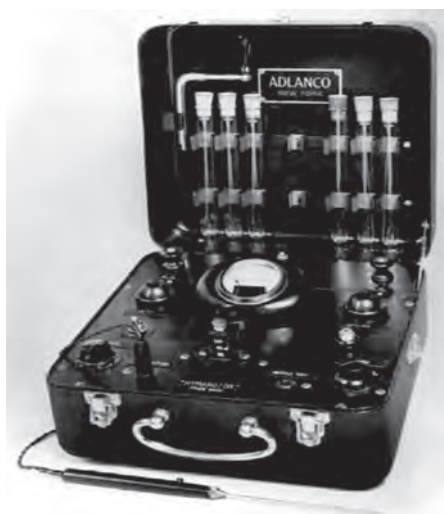
Slika 1. Hymanov pejsmejker iz 1932 sa električnom iglom za direktni kontakt sa grudnim košem i srcem.
